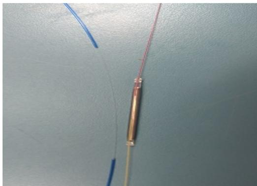
Na quinta etapa os tubetes são dispostos na fibra recém-emendada e em seguida levada na parte superior da máquina que possui um tipo de forno que aquece o tubete, ocorrendo o derretimento desse material que é feito de plástico. Depois desse derretimento a fibra estará pronta para ser acomodada nas caixas de emendas.
