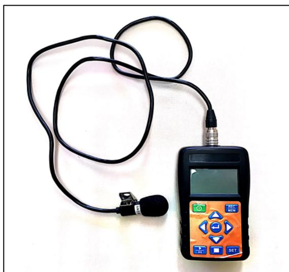
A função do aparelho (Figura 2) é fornecer e armazenar as medidas do NPS equivalente, ao mesmo tempo em que faz a dosimetria. No caso deste estudo, o processo de dosimetria seguiu os parâmetros específicos de medição, conforme a recomendação da NR-15, como o tempo de
