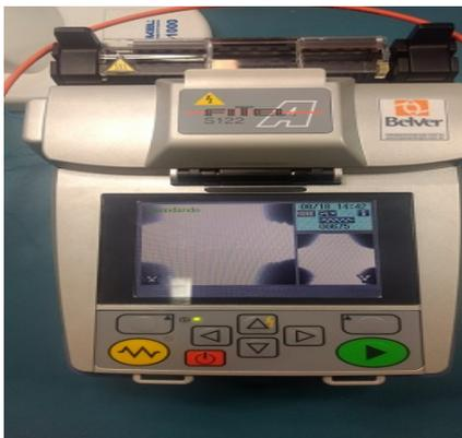
Depois da fusão pronta a máquina só soltará a fibra óptica depois de um teste de tração para certificar que a fusão foi realizada com sucesso e que não que ocorrerá nenhum tipo de problema. Esse tipo de teste pode ser observado pelo operador da máquina, ou seja, as fibras serão levemente puxadas para trás pela própria máquina.
