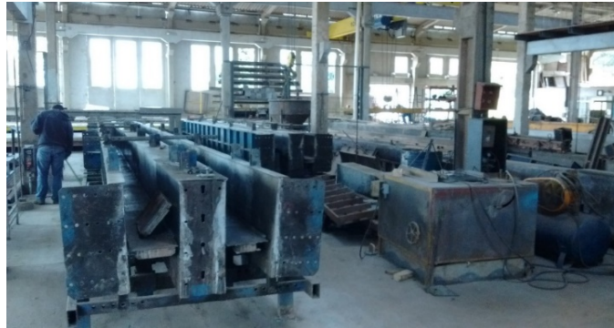
Figura 4 – Desorganização no setor de fabricação de vigas e pilares
