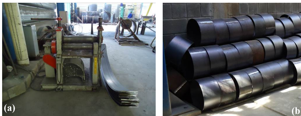
Figura 6 – Máquina Calandra (a) e as chapas de aço curvadas (b) originadas do processo de calandragem
