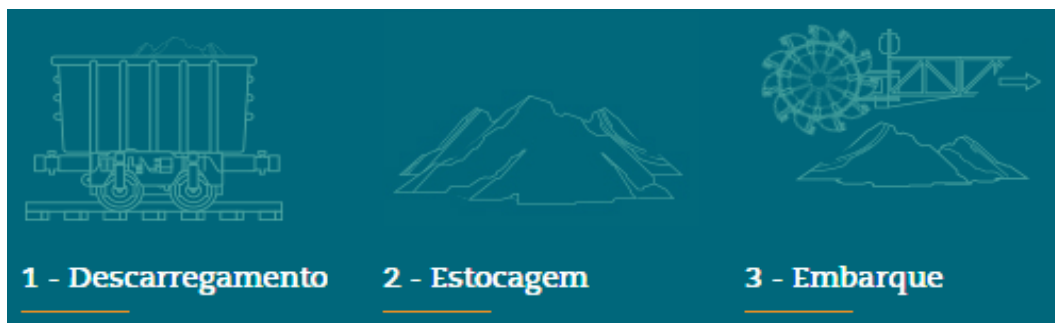
Figura 2 - Processo operacional dos Portos que exportam minério de ferro
